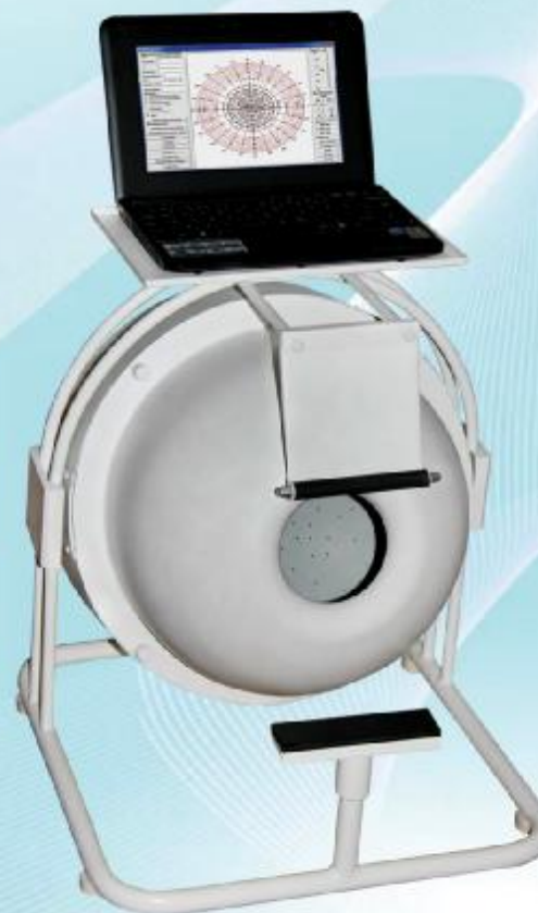
Периграф «ПЕРИКОМ» исполнение 01 «Классика - мини» с «Нетбуком» - LCD экран 10.1" (принтер не показан)
